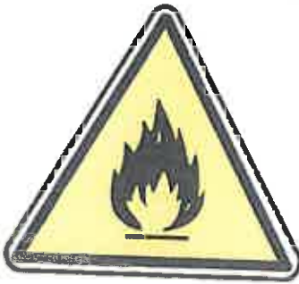
Matières inflammables ou haute température (*)
