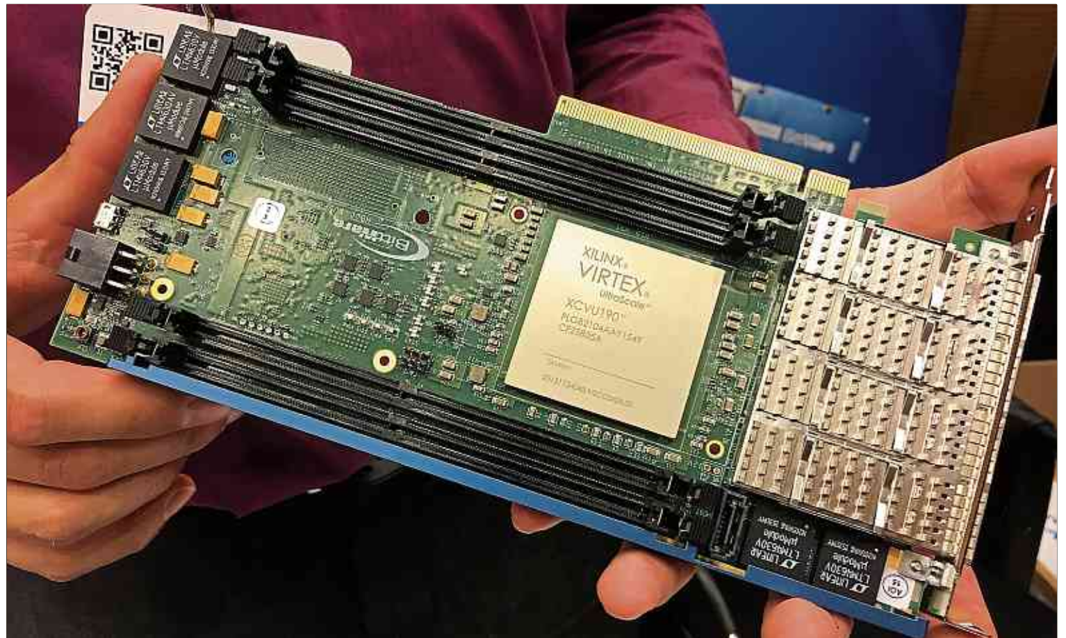
Un exemple d'«armoire de filtrage». A droite, les quatre barrettes métalliques où entrent quatre fois 100 Gbps. Le carré central, doté de logiciel et d'intelligence artificielle, détecte le trafic néfaste et le bloque. Le cœur du futur centre national de mitigation. (PHOTO: THIERRY LABRO)
